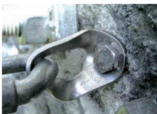
axiale Belastung eines Schraubankers
