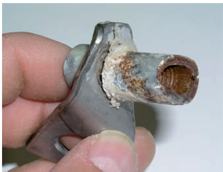
Korrosion im Dübelhohlraum zwischen Schraube und Spreizkonus führte zum Bruch des Systems bei einem normalen Sportklettersturz. Von außen war dem Haken nichts anzusehen.
