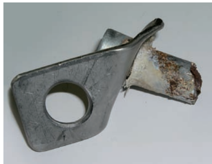
Korrosion im Dübelhohlraum zwischen Schraube und Spreizkonus führte zum Bruch des Systems bei einem normalen Sportklettersturz. Von außen war dem Haken nichts anzusehen.
