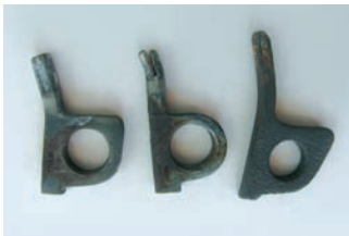
Sticht-Bohrhaken aus den 1950-er und 1960-er Jahren
